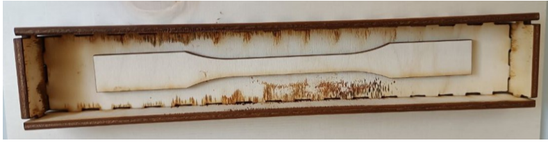
Fig. 2. Mould for the silicone mould. Sample type 1B (EN ISO 527-2:2012)
